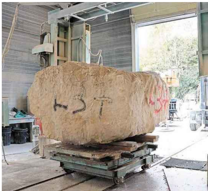
La palette, sur laquelle est posé le bloc, vient ajuster le roc sous la lame.
